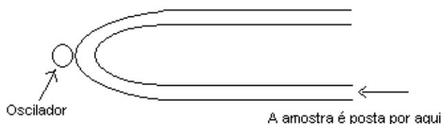
Fig.1 Tubo em U do Densímetro Digital
