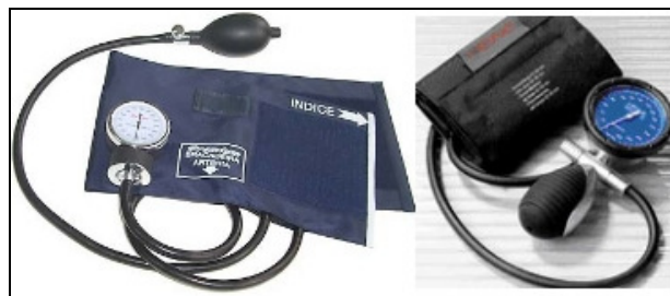
Fig. 3. Exemplos de esfigmomanômetros aneróides
