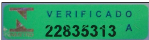
Fig. 2. Marca de verificação de termômetros clínicos
