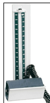
Fig. 4. Exemplo de esfigmomanômetro de líquido manométrico
