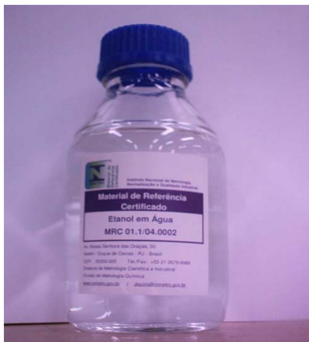
Figura 3: Imagem do Material de Referência Certificado (MRC) para verificação do etilômetro
