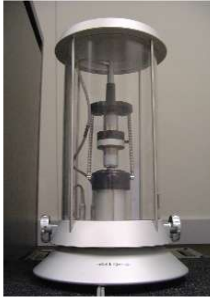
Figura 2.11 – Montagem para a calibração por reciprocidade em campo de pressão (Inmetro).
