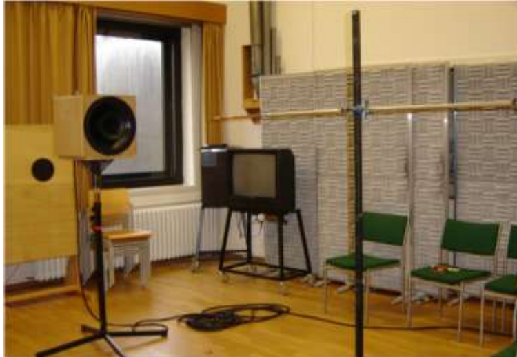
Figura 2.9 – Montagem para a calibração por comparação seqüencial em campo livre simulado (PTB) [12].
