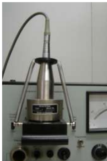
Figura 2.6 – Montagem para calibração por comparação seqüencial em campo de pressão utilizando um acoplador (Inmetro).
