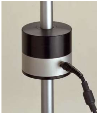
Figura 2.5 – Montagem para calibração por comparação simultânea em campo de pressão utilizando um acoplador (Inmetro).
