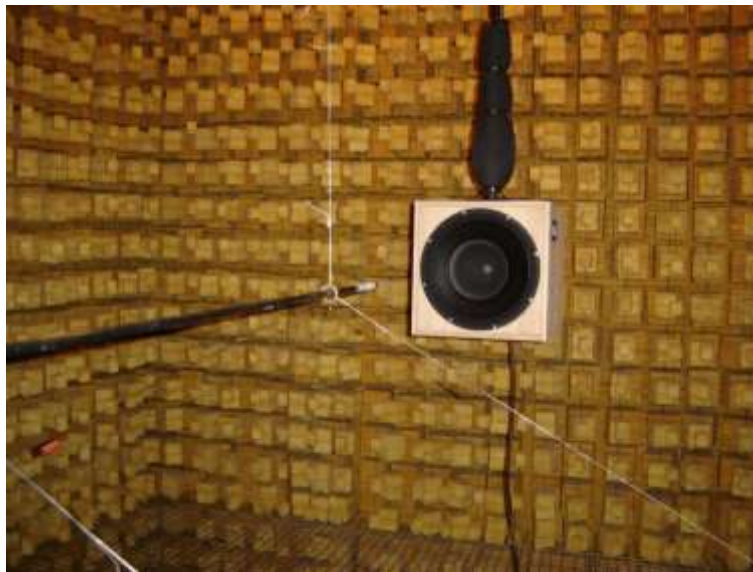
Figura 2.8 – Montagem para a calibração por comparação seqüencial em campo livre (Inmetro).
