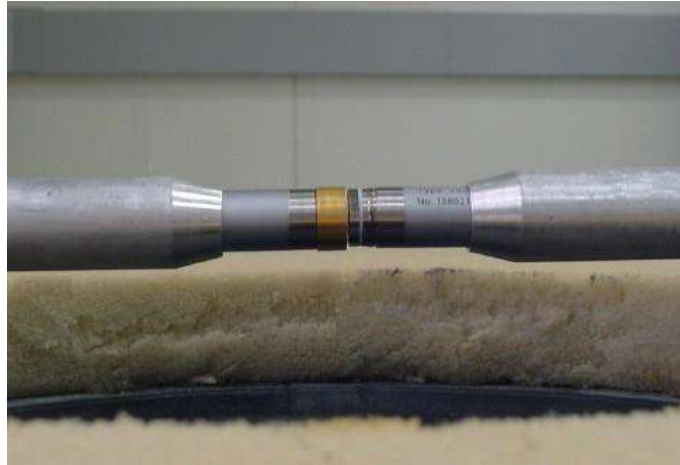
Figura 2.4 – Montagem para calibração por comparação simultânea em campo de pressão utilizando um jig (Inmetro).
