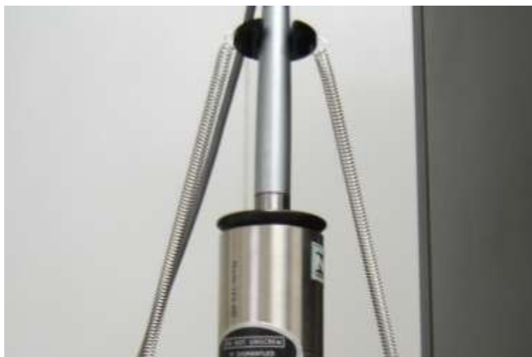
Figura 2.3 – Montagem para a determinação da sensibilidade utilizando um pistonfone (Inmetro).
