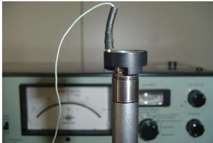
Figura 2.2 – Montagem para a determinação da resposta em frequência com o atuador eletrostático (Inmetro).
