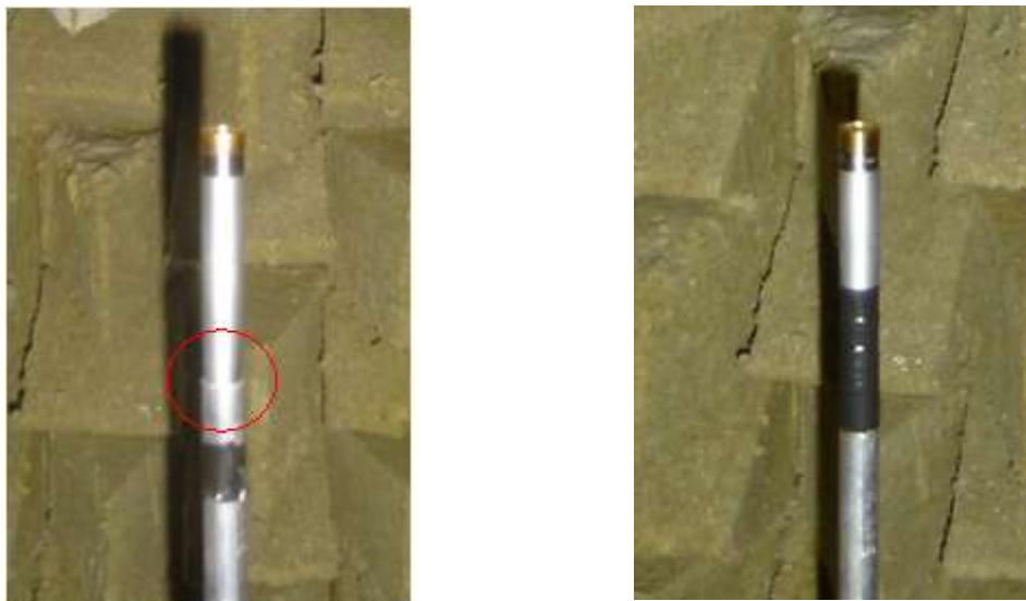
Figura 4.36 – a) descontinuidade entre o pré-amplificador e a haste; b) redução desta descontinuidade com a utilização de fita adesiva.
