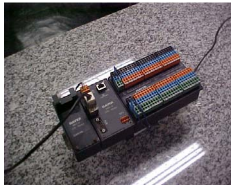
Foto # 5 – Módulo controlador do sistema eletrônico de pesagem e dosador. Laboratório INMETRO/DIMEL/DIMAS
