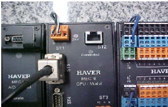
Foto # 4 – Porta ST 2, interface ETHERNET, conector RJ 45. Laboratório INMETRO/DIMEL/DIMAS
