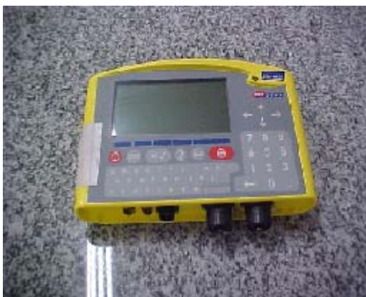
Foto # 1 – Dispositivo indicador XR 3000 – TRU-TEST FARM TECH, de instrumento de medição de massa para pesagem de gado.
