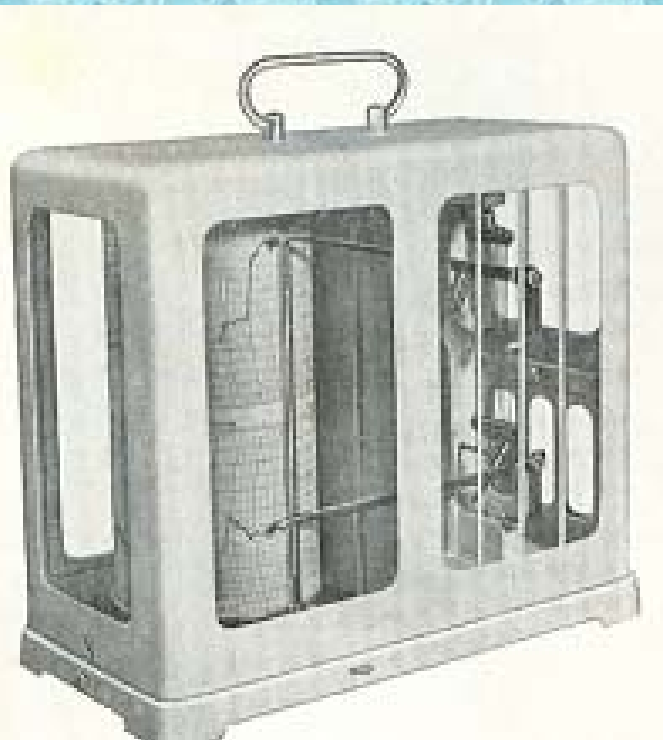
Fig. IV.7 - Termohigrógrafo (registrador de temperatura e umidade) convencional (acima) e parte de um termohigrograma (abaixo).
