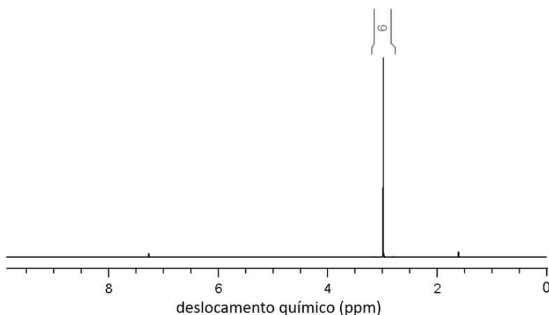
Figura 1: Espectro de RMN de  $^1\text{H}$  a 400 MHz para dimetilsulfona a 17 mg/mL em  $\text{CDCl}_3$
