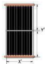
Figura 3. Medidas da área transparente de coletores solares fechados
