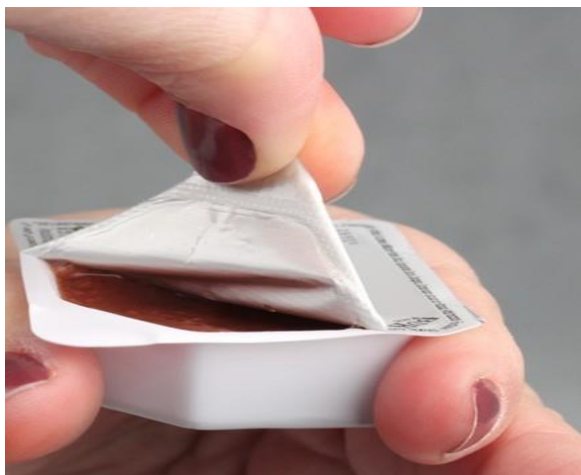
Figura 4 – Descolamento integral da tampa
