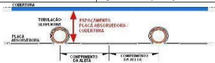
Figura 5. Medida do espaçamento entre Placa Absorvedora e Cobertura de coletores solares fechados
