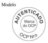
Nota: Diâmetro externo =  $30 \pm 1$  mm e diâmetro interno =  $15 \pm 1$  mm.
