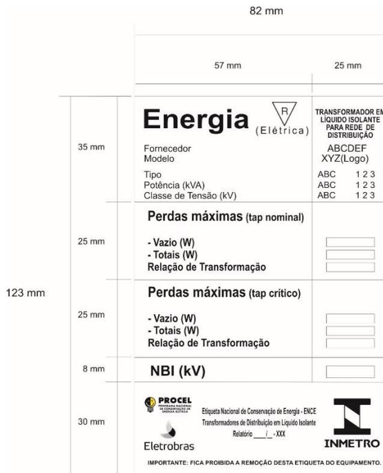
Figura 3 - Modelo da ENCE para equipamentos REFORMADOS
