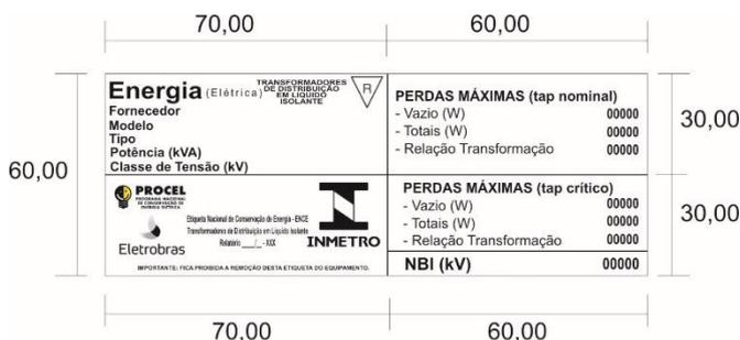
Figura 4 - Modelo da ENCE Reduzidos para equipamentos REFORMADOS
