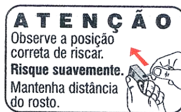
Figura 1 – Desenho esquemático da forma correta de utilização
