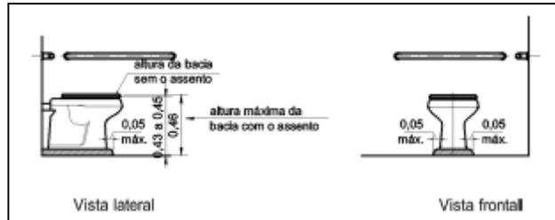
Figura 14 - Adequação da altura do vaso sanitário (Figura 121 da norma ABNT NBR 9050).
