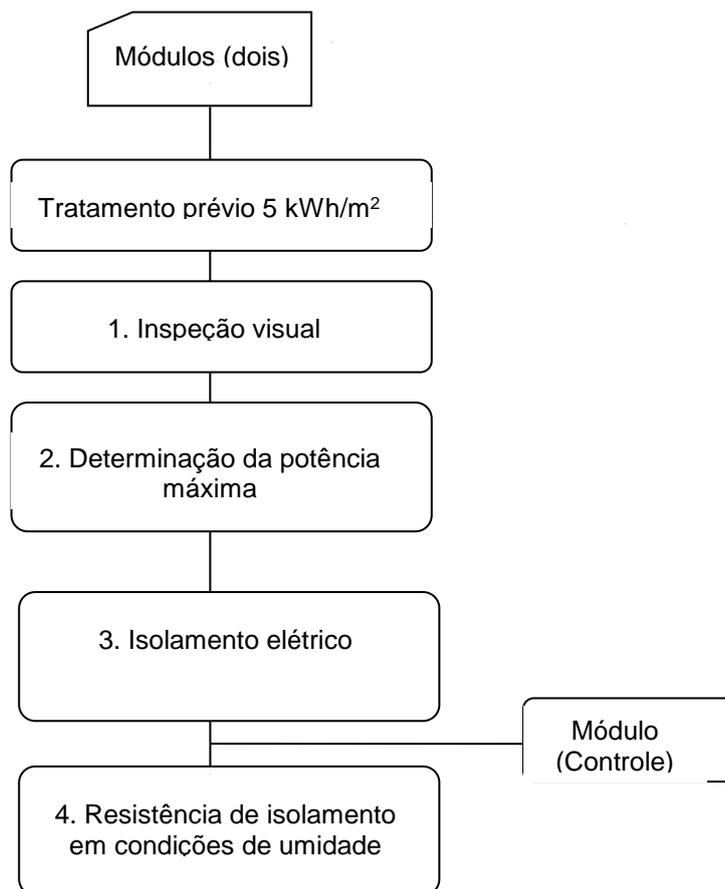
Figura 1 - Fluxograma de ensaios dos módulos
