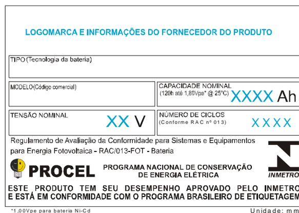
Figura 8 - Modelo da ENCE para Baterias
