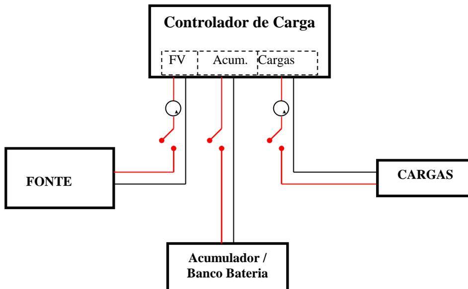
Figura 2 - Diagrama de conexões dos instrumentos de medição e aparelhos para medição das tensões de fim de carga, de desconexão do painel e reposição do painel.
