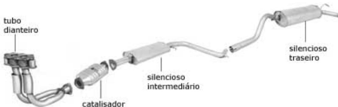
*No sistema de escapamento, silenciosos e conversores têm funções diferentes/ Fonte: OG Sistemas de Exaustão*
