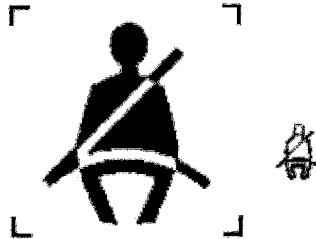
Figura 9 Cintos de segurança ISO 2575 nº 4.18 Cor da luz piloto: vermelha
