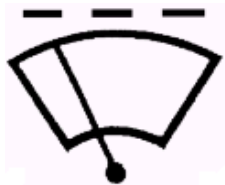
Figura 5 Limpador de pára-brisas intermitente ISO 2575 nº 4.45
