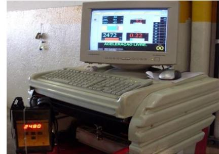
**RUÍDO DE FUNDO:** Após ensaio do veículo considerado aprovado ou reprovado, ao medir o ruído de fundo (inicial e final), manter o motor do veículo ligado para que a diferença deste em relação aos valores medidos no ensaio seja menor do que 03 db(A) e confirmar a coerência de rejeição do ensaio pelo equipamento.
