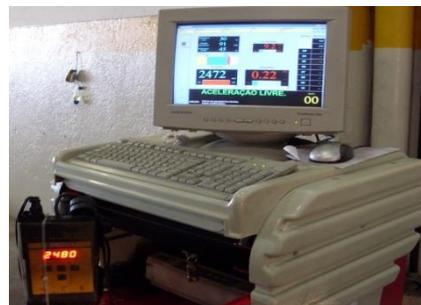
**OPACIDADE:** Retirar gradativamente a sonda do escapamento do veículo livre (corte) e de marcha lenta, observando a esperada redução do valor K da opacidade e confirmar a coerência de aprovação pelo equipamento. Confirmar se o opacímetro registra valor = a zero
