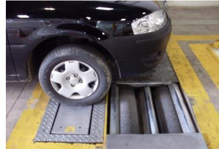
**DIREÇÃO:** Movimentar placa de alinhamento para a direita, medir deslocamento lateral real (mm) e o comprimento da placa (m). Dividir um valor pelo outro conforme fórmula a, confrontar com o resultado apresentado pelo equipamento e verificar coerência. Repetir procedimento para a esquerda. Na sequência, verificar retorno automático tanto da placa quanto do valor medido ao 0 (zero).
