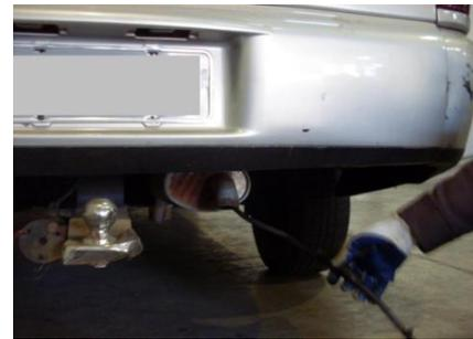
**ESTANQUEIDADE:** Ao iniciar o equipamento, não estancar (interromper o bocal) da sonda quando solicitado inicialmente pelo software e verificar se, corretamente, o teste de estanqueidade do sistema é reprovado impedindo assim a realização de ensaios oficiais.
