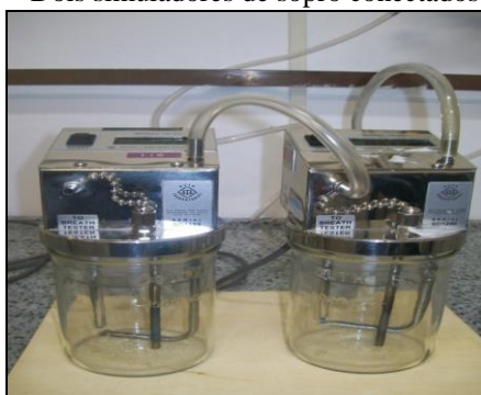
Figura 4 – Dois simuladores de sopro conectados em série.
