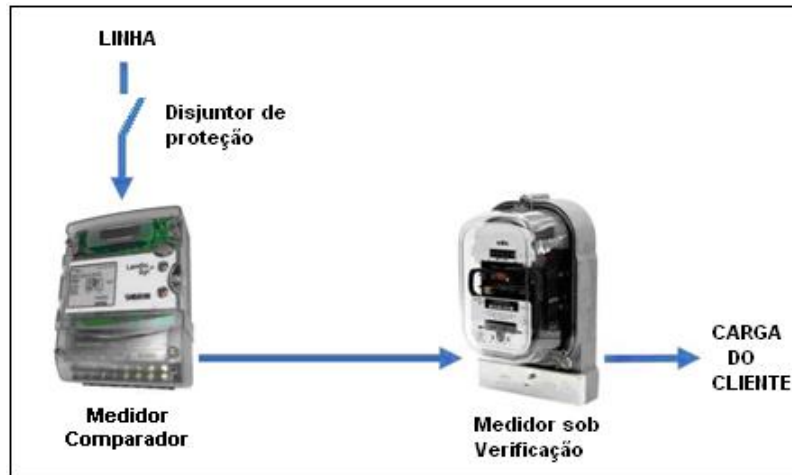
Figura 03 – Esquema de ligação para verificação por medidor comparador antes
